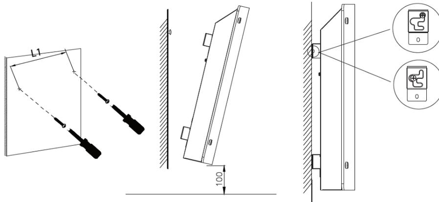
Zum Anbringen den Schraubenkopf in die rückseitige Halterung einführen
