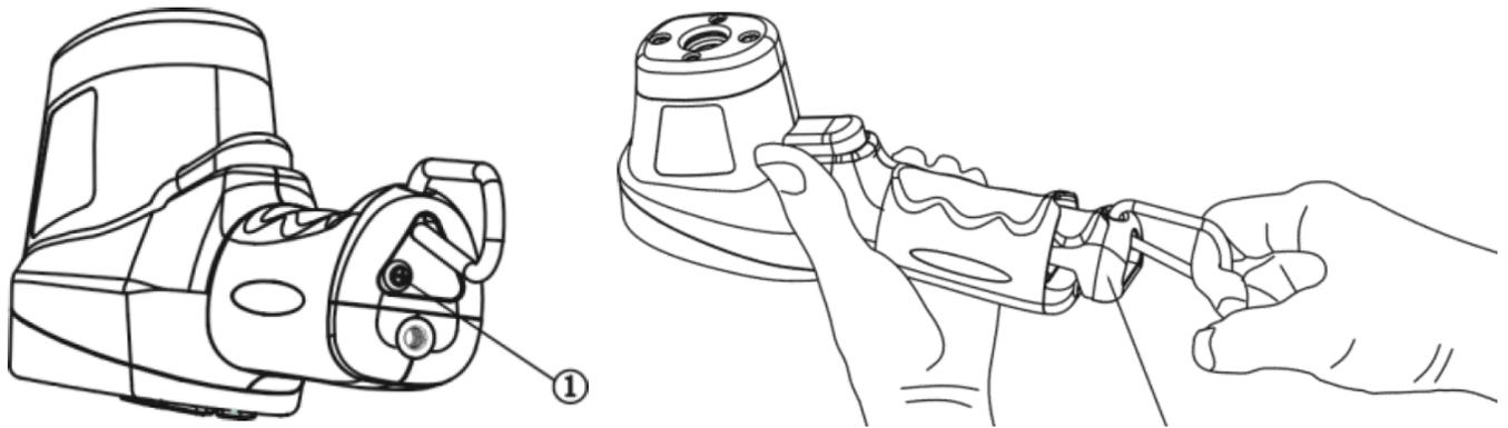
Entfernen Sie die Schraube (1) auf der Unterseite des Gerätes mit einem Schraubenzieher.
